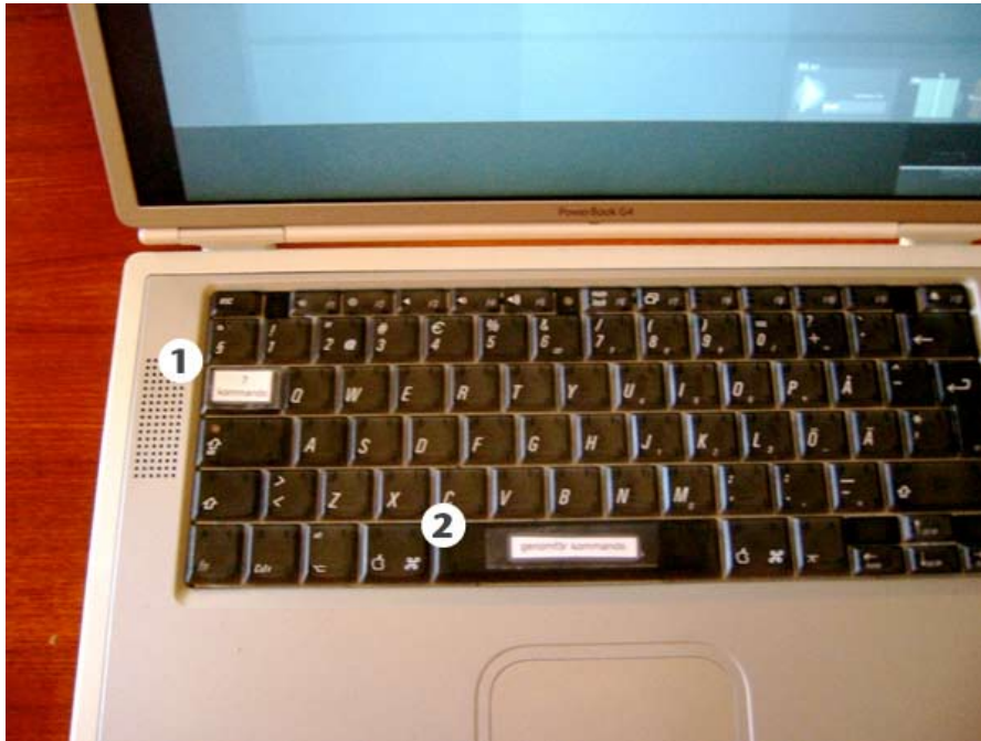
Figur 4.14 HJÄLP- och KOMMANDOTANGENTER – Modifiering av tangenternas märkning (1) "? kommando" - hjälptangent för lista med kommandon, (2) "genomför kommando".
