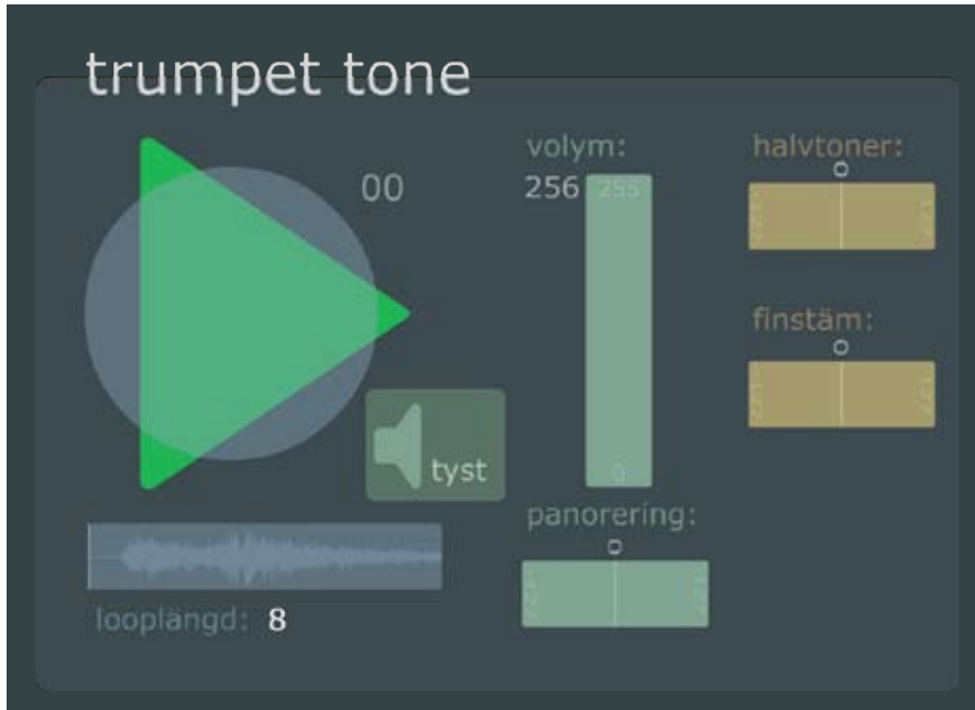
Figur 4.9 ILLUSTRATION av LOOPKOMPONENT – Layouten förbättrades senare och slider-reglagen blev tvådimensionella med två parametrar på x- respektive y-axel.
