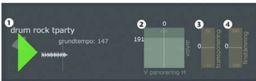
Figur 4.10 SLUTLIG DESIGN av LOOPKOMPONENTEN I ARRANGEMANGSVY – Utseende för loopkomponent i prototypen med (1) ljudklippet med rubrik, play-knapp (triangel), progressionsfeedback i form av ett paj-diagram (snurrar medurs), tempoinformation och vågformsgraf med progressionsfeedback som löper från vänster till höger. (2) tvådimensionell volym och panoreringskontroller. Kontroller för tonhöjd (3) och finstämning (4).
