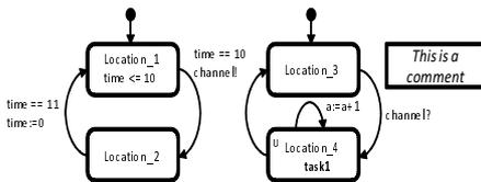
Fig. 2. Example task automata
