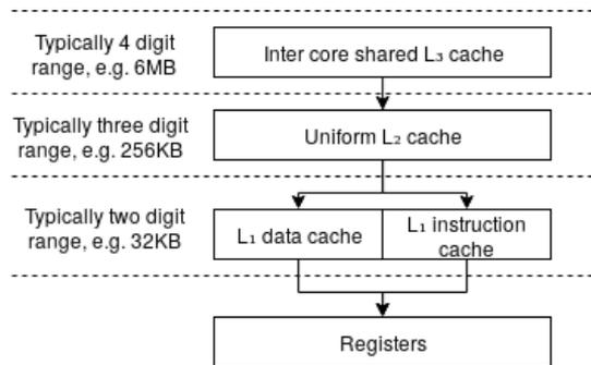
**Figure 2.6:** Intel<sup>®</sup> Core<sup>™</sup> i5-3570k cache hierarchy
